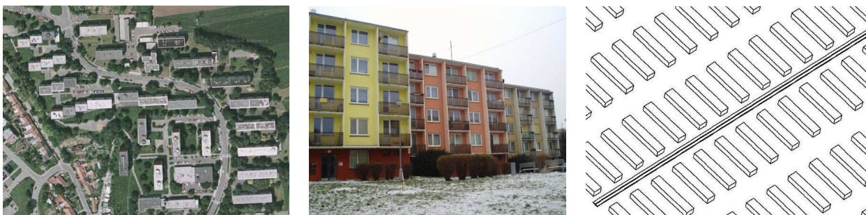
Obr. 9 Ukázka městské části s navazujícími panelovými domy a jejich znázornění v matematickém modelu
