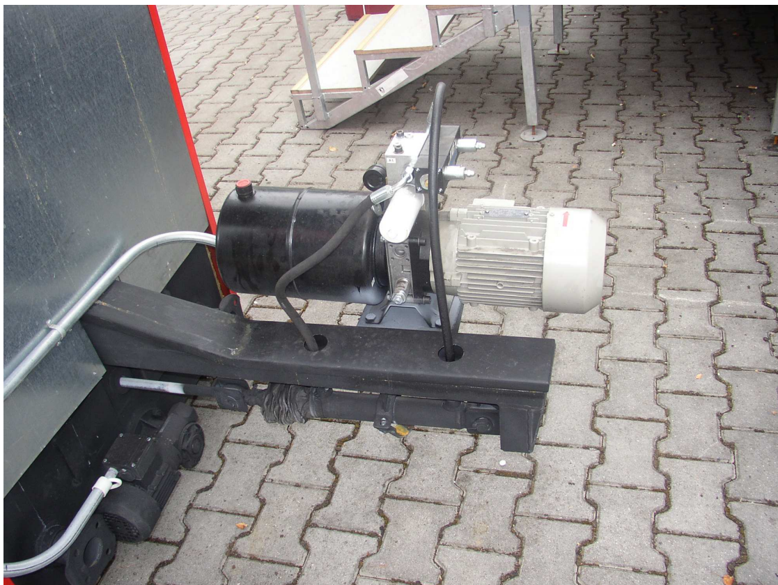
Obrázek č. 7 Hydraulický agregát s pracovním válcem pro automatický pohyb zařízení pro čištění roštu kotle o výkonu 100 kW
