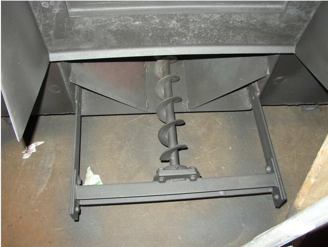
Obrázek č. 6 Automatické vyhrabovací zařízení popele u kotle o výkonu 150 kW
