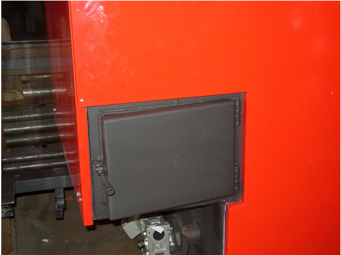
Obrázek č. 10 Boční čistící dvířka pro odstraňování popele u kotle o výkonu 150 kW
