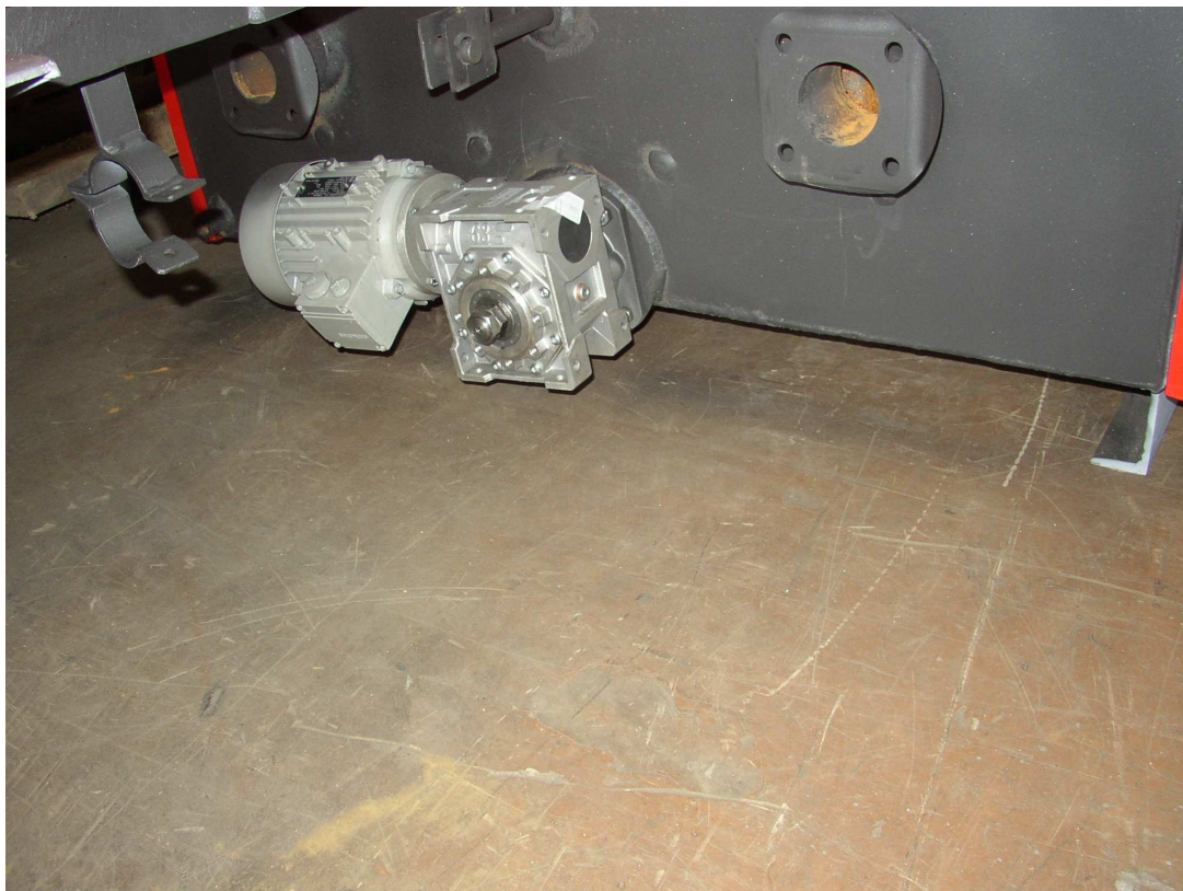
Obrázek č. 4 Převodovka s motorem pro pohon zařízení pro vynášení popele z popelníku u kotle o výkonu 150 kW
