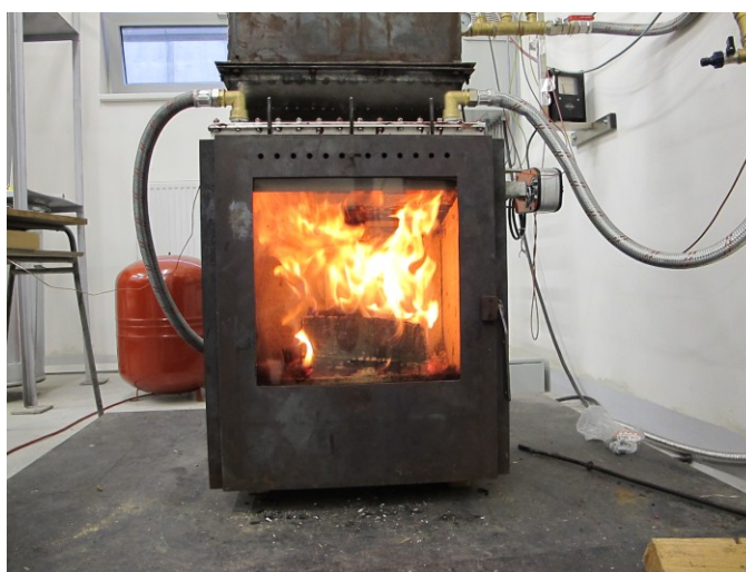
Obr. 1 Zkonstruovaná spalovací jednotka s termoelektrickým generátorem
