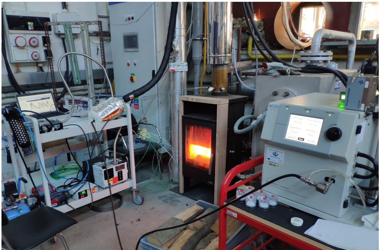
Obr. 2 Měření na experimentálních krbových kamnech (vlevo - měření teplot a řízení; vpravo – SMPS zařízení pro měření velikostní distribuce a koncentrace jemných částic)
