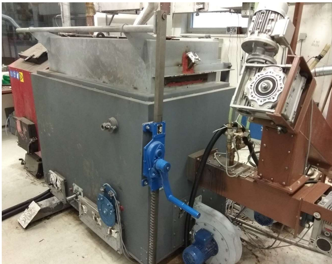
Obr. 2: Foto zplyňovací komory ZKG S v laboratoři Energetického ústavu
