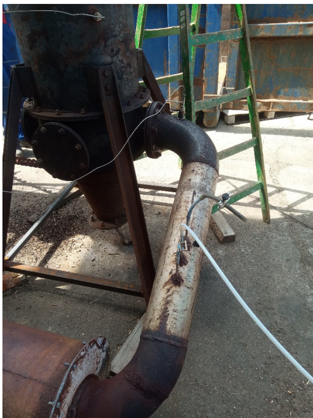
Obrázek 4: Odběrové místo generované plynu pro online měření emisí a množství dehtů.
