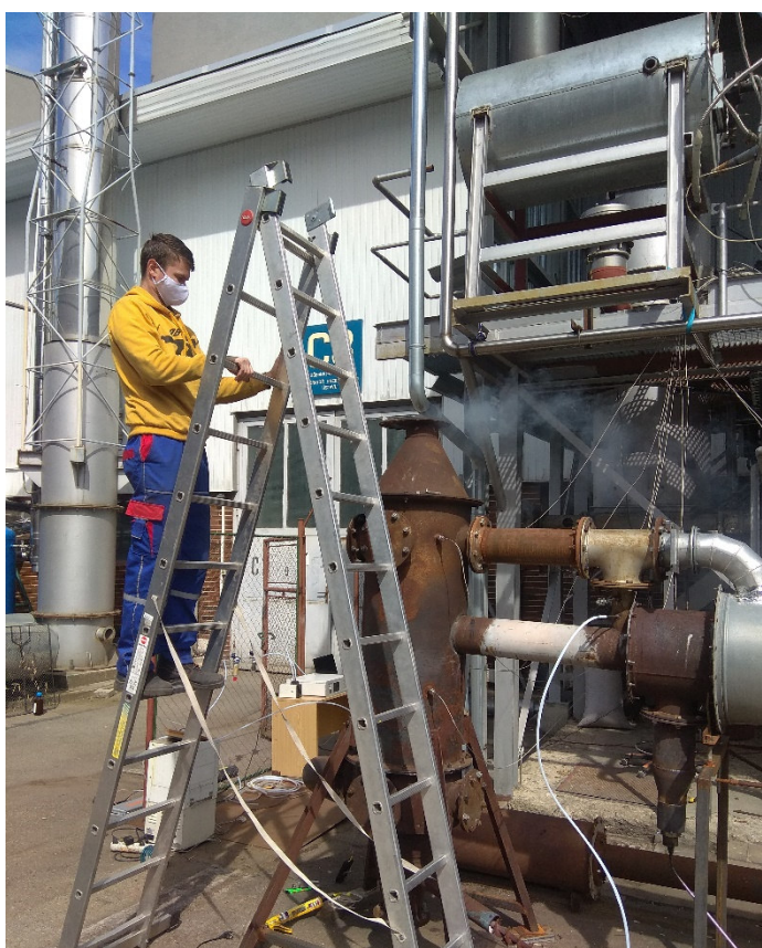
Obrázek 5: Vizuální kontrola výšky pevného lože.
