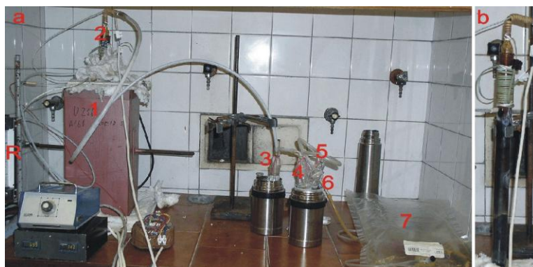
Obr. 2 Fotografie experimentální aparatury (a) a pyrolýzního reaktoru (b), označení jako na Obr. 1
