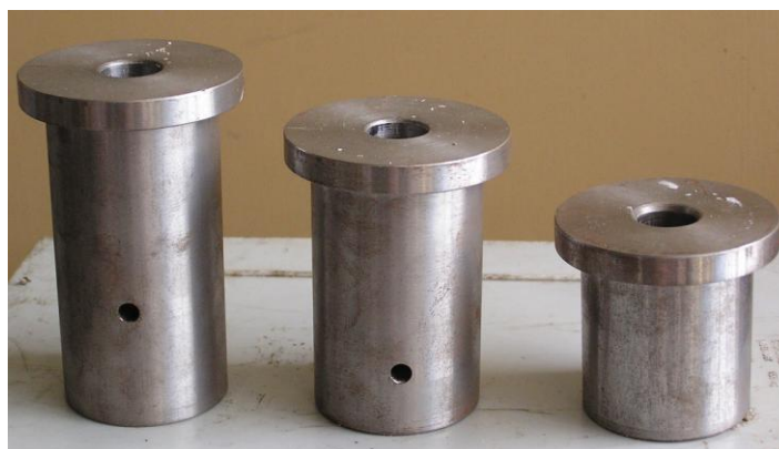
Obr. 6 Lisovacie komory s rôznymi dĺžkami (zľava do prava – 120mm, 100 mm, 80 mm )
