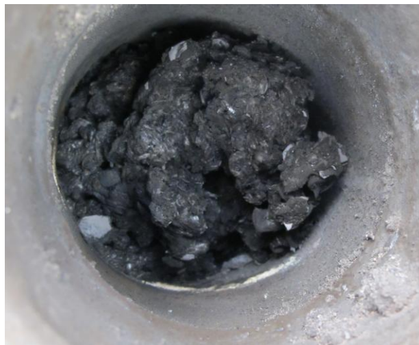
Obr. 8 Pohled do spodní části fluidního lože reaktoru (dochází k zapěchování vstupu vzduchu i paliva)
