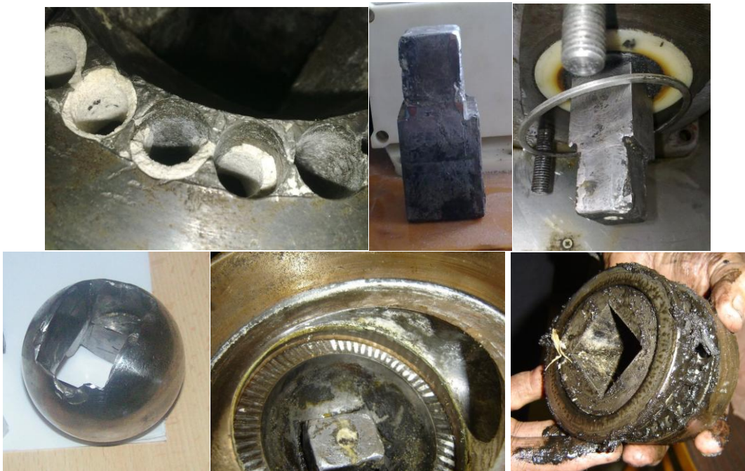
Obr. 8 Dôležité súčiastky zariadenia V1 po dlhodobej skúšobnej prevádzke
