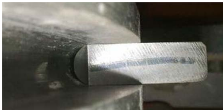
Obr. 5 Nepresné dosadnutie lisovacieho prstenca do lisovacieho kotúča.
