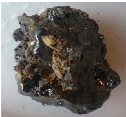
Obr. 1 Slinuté popeloviny a materiál vrstvy ze spalovací zkoušky paliva AF1.
