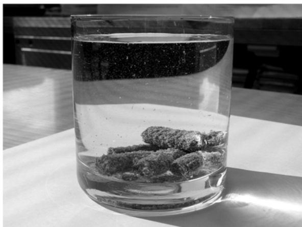
Obr. 11 Pelety zo sena – skúška tvrdosti ponorom [5].
