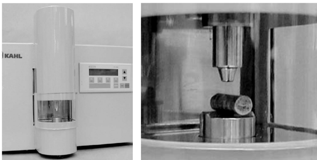
Obr. 10 Zariadenie na testovanie tvrdosti peliet od firmy KAHL [1].
