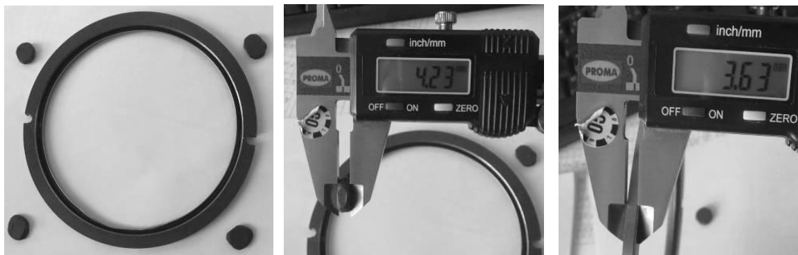
Obr. 4 Meranie reálnych vzdialeností sústavy krúžkov a rozmerov teliesok
