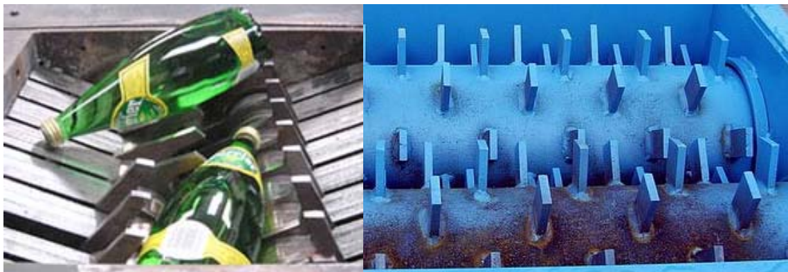
Obr. 4 Príklady konštrukcie pracovného priestoru pre dezintegráciu krehkých materiálov
