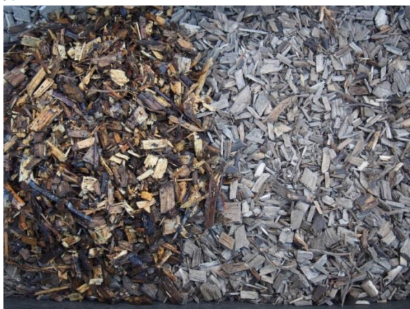
Obr. 4 Dřevní štěpka před a po vysušení
