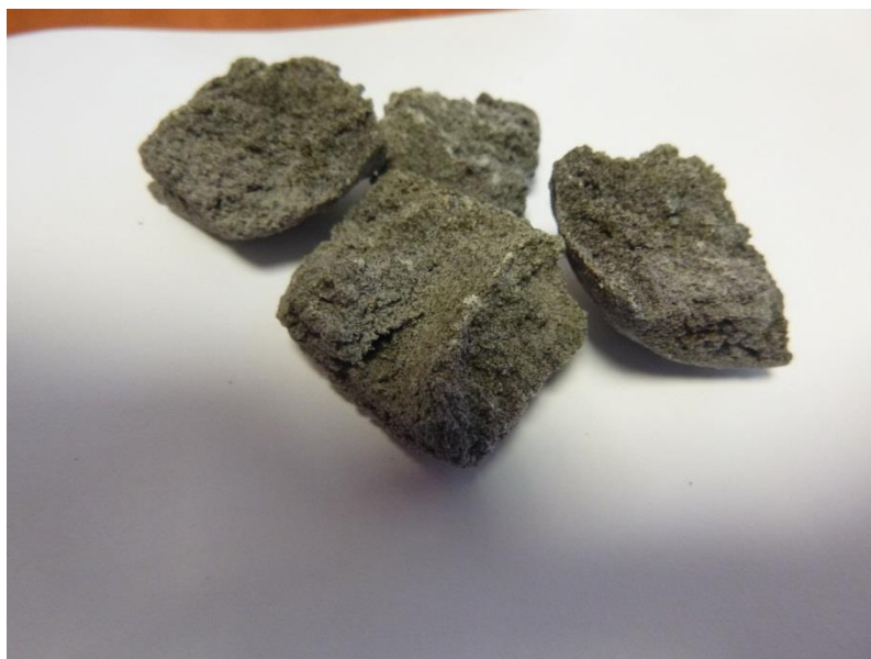
Obr. č. 3: Spečený popel při teplotě 815 °C v žíhací peci.
