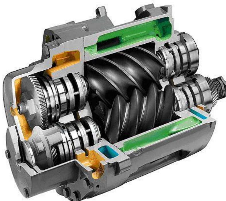
Obr. č. 2 Pracovní prostor šroubového kompresoru - šroubovice
