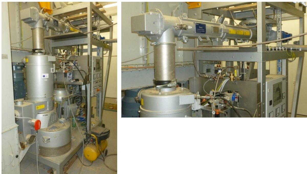
Obrázok 2. Peletovací lis KAHL 33-390 (vľavo) a pohľad na lopatkový homogenizátor s vodnou tryskou (vpravo)
