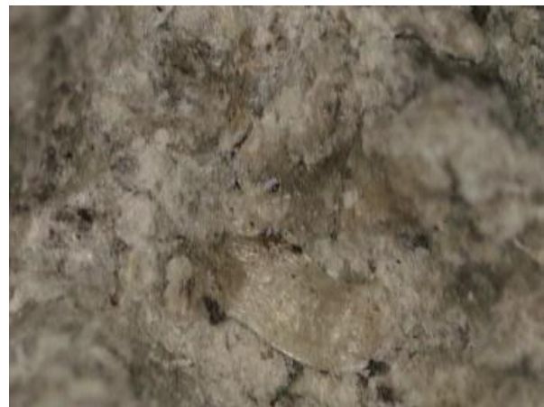
b) priblížený pohľad (40x) na povrch peliet pozdĺž osi pelety - vzorka 1
