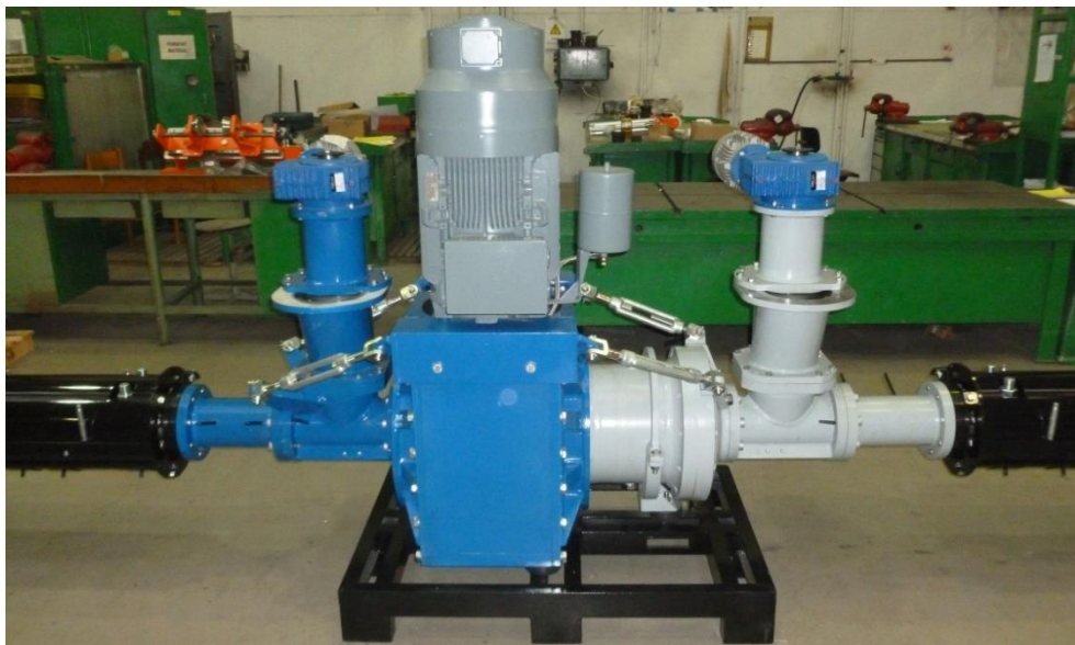
Obr. 6 Výsledok výskumu a vývoja - dvojkomorový závitkový briketovací lis
