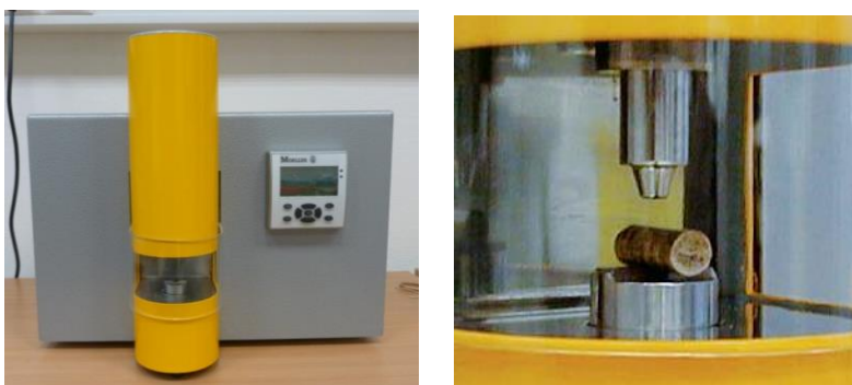
Obr. 6 Použité zariadenie na testovanie tvrdosti peliet od firmy KAHL
