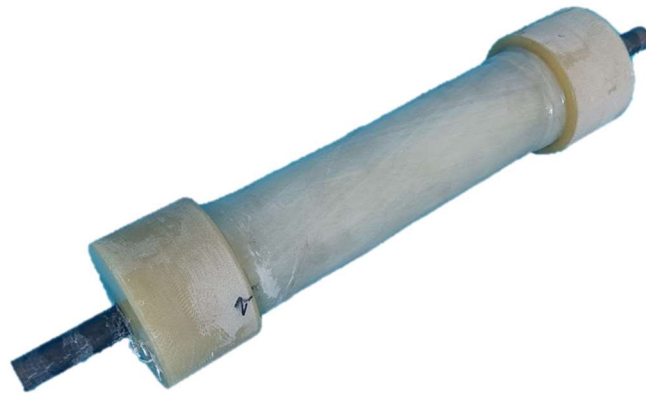
Obr. 2 Konstrukce svazkového tepelného výměníku z polymerních dutých vláken.
