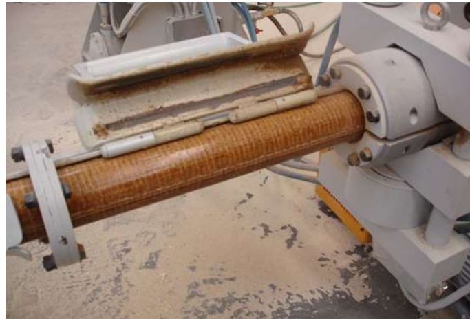
Obr. 1 Briketa ako jediný výlisok vytváraný v jednom časovom okamihu
