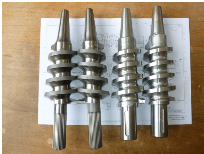
Obr. 5 Monolitná konštrukcia lisovacej závitovky
