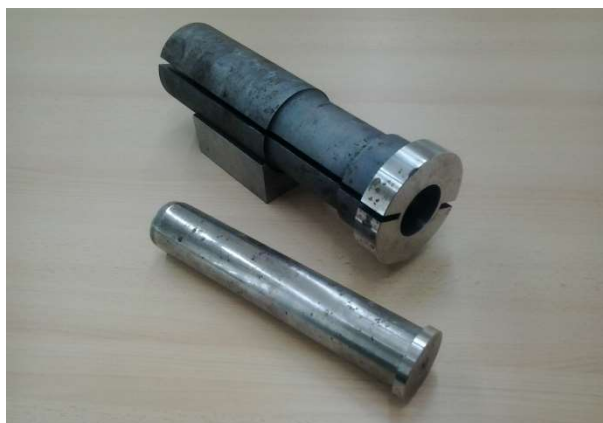
Obr. 2 Lisovacie nástroje hydraulického lisu - lisovacia komora, lisovací piest
