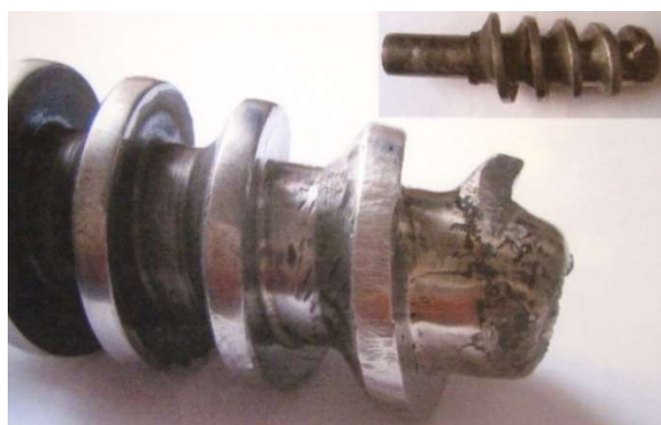
Obr. 14 Opotrebovaný koniec lisovacej závitovky
