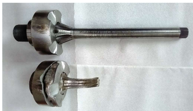
Obr. 4 Porucha korunky a trňa piesta kľukového briketovacieho lisu
