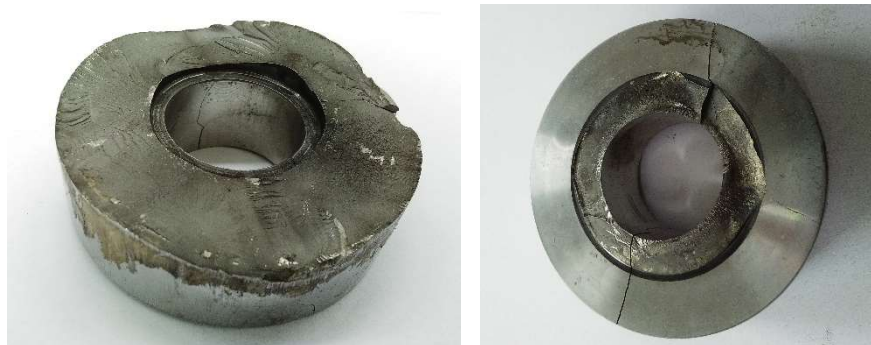
Obrázok 6: Porucha korunky piesta – krehký lom
