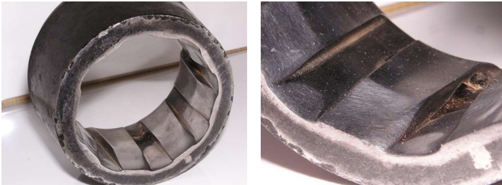
Obr. 11 Opotrebovaná hubica závitkového briketovacieho lisu
