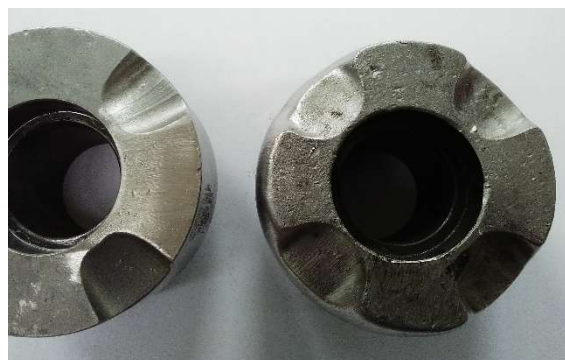
Obr. 8 Porovnanie miery abrazívneho opotrebenia na korunke lisovacieho piesta
