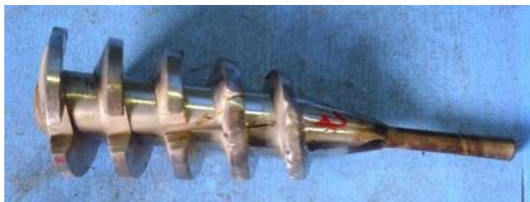
Obr. 3 Opatrebenie závitov lisovacej závitovky
