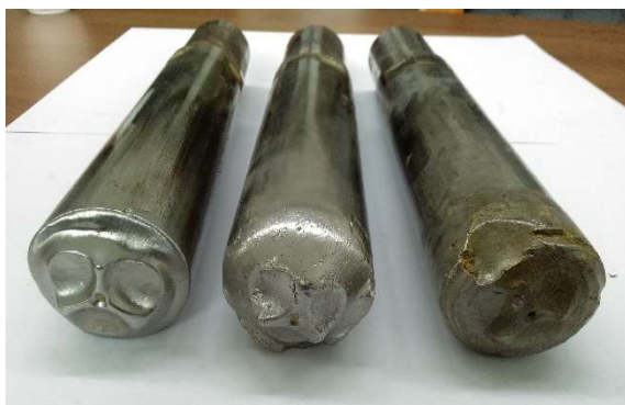
Obr. 7 Abrazívne opotrebenie povrchu monolitných lisovacích piestov
