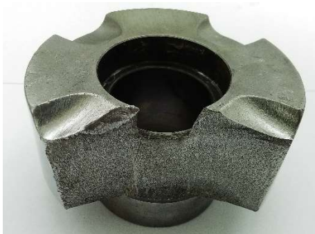
Obrázok 5: Porucha korunky piesta –únavový lom
