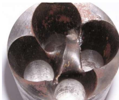
Obr. 2 Deformačné poškodenie peletovacej vložky vloženej do briketovacej hubice
