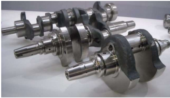
Obr. 9 Kľukový hriadel' briketovacieho lisu – a) nové vyrobené kusy; b) ukážka lomu
