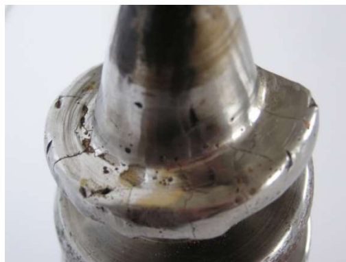
Obr. 12 Opotrebovaný povrch závitovky briketovacieho lisu
